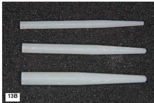
**Figura 13A y 13B:** PBORF con fibras de vidrio y matriz de dimetacrilatos con adecuadas propiedades físicas.
