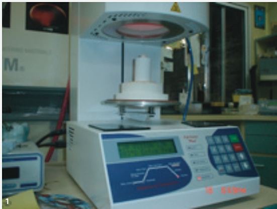
Figura 1: Horno de laboratorio para sinterización de porcelana. Nótese la platina que soporta a las restauraciones; asciende una vez puesta en funcionamiento y seleccionado el programa hasta quedar totalmente incluida dentro del horno, y completar así el proceso de cocción o sinterización. La fotografía es gentileza del Sr. Mario Coco Bañay (Buenos Aires, Argentina).
