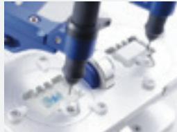
Figuras 13A y 13B: Sistema para fresado manual de bloques de zirconio presinterizado Ceramill (Girrbach). Obsérvense las dos puntas del dispositivo. La ubicada sobre la izquierda de la imagen copia la forma del encerado de la estructura, y la fresa (sobre la derecha) desgasta el bloque de zirconio preseinterizado reproduciendo la forma. El sistema se acciona en forma totalmente manual y recuerda a un sistema de duplicado de llaves. Una vez modelado el bloque de zirconio, se retira de platina para su sinterización final en un horno. Luego se hacen los ajustes finales sobre el modelo. Las imágenes son gentileza de la compañía Olympic Dental.
