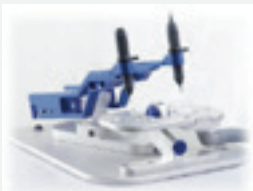
Figuras 13A y 13B: Sistema para fresado manual de bloques de zirconio presinterizado Ceramill (Girrbach). Obsérvense las dos puntas del dispositivo. La ubicada sobre la izquierda de la imagen copia la forma del encerado de la estructura, y la fresa (sobre la derecha) desgasta el bloque de zirconio preseinterizado reproduciendo la forma. El sistema se acciona en forma totalmente manual y recuerda a un sistema de duplicado de llaves. Una vez modelado el bloque de zirconio, se retira de platina para su sinterización final en un horno. Luego se hacen los ajustes finales sobre el modelo. Las imágenes son gentileza de la compañía Olympic Dental.
