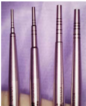
Figura 3- Juego de osteotomos basados en SUMMER.
