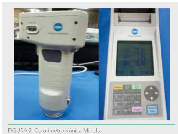
FIGURA 2: Colorímetro Kónica Minolta
