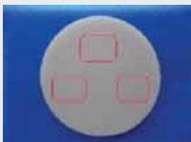
FIGURA 3: Disco de resina polimetilmetacrilato donde se observan las diferentes zonas del registro del color
